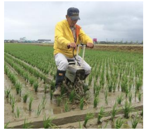
乗用溝切機を使用した溝切り
